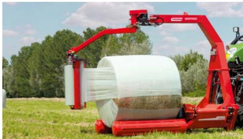
Singolo satellite a elevata velocità di rotazione
